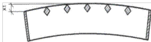
Bolrond xl max. 1/150 van de lengte >450mm; max. 8mm; <450mm max. 3mm
