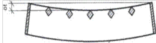
Holrond ol max. 1/200 van de lengte >600mm; max. 8mm; <600mm max. 3mm
